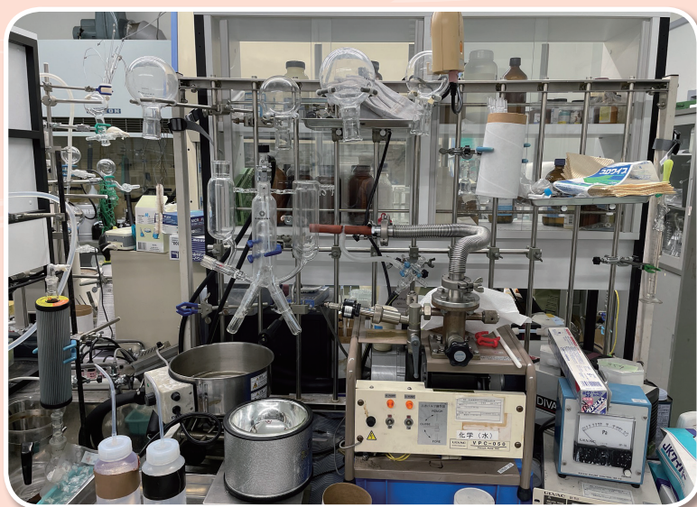
圖一、溶劑輔助風味蒸發萃取 (SAFE) 裝置。
