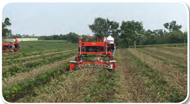
圖二、換袋式採茶機中剪作業情形
