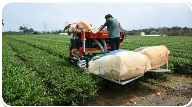
圖一、換袋式採茶機採收需 2 人作業
