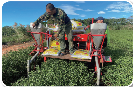
圖一、乘坐式採茶機之施肥附掛機組作業情形。
