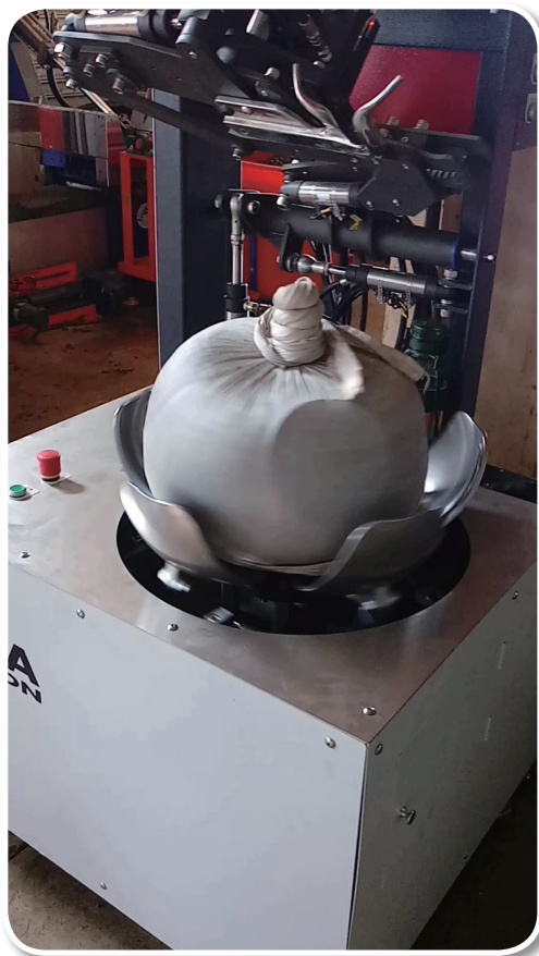
圖二、全自動束包機機械手臂，全程電腦程式自動化捆綁布巾上束結。
